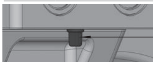
Drenaggio della condensa
