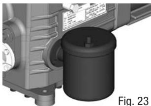
Regulador mecánico del nivel de aceite en la conexión "O"
